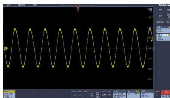
图 4 开关电源 230W 时 PFC 偏置电压消除后的纹波
