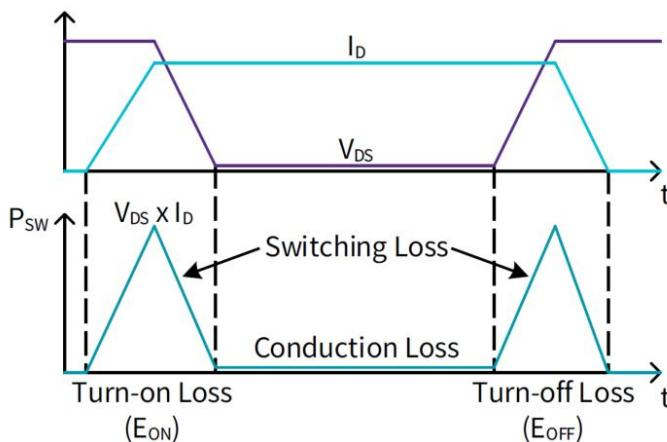
下面是一个测试案例中，我们把电压探头和电流探头准确的相对延时 7ns 输入到示波器的对应通道进行延时补偿。此时示波器计算出准确的开通损耗  $E_{ON}=535\mu J$ 。
