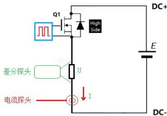
本公司的 **DF6800 偏移校准夹具** 就是这样实现测量两个电压电流探头之间的相对延时参数 skew。
