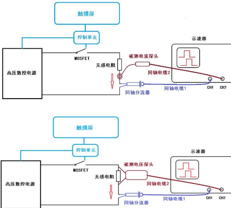
用户可以在触摸屏上设定高压脉冲的电压幅度。当用户按动触发按钮，MOSFET 导通，无感电阻上产生一个高压脉冲（可以高达几百伏），同时在回落中也产生一个完全同步的电流脉冲信号。因为是无感电阻，所以该电阻上的脉冲电压  $U$  和脉冲电流  $I$  是同相位的，或者说脉冲电压波形和脉冲电流波形是没有延时的。
