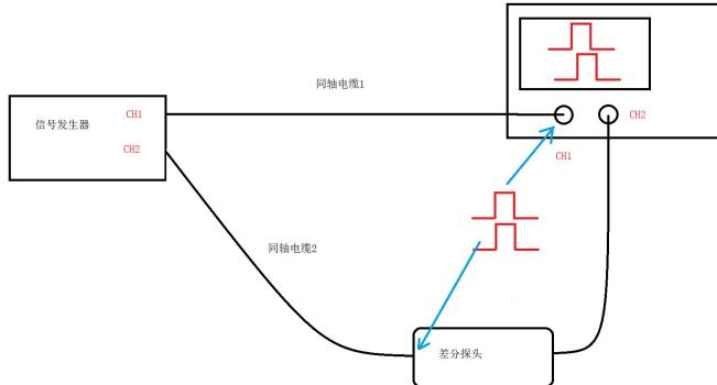
现有的绝对延时参数的测量方法如上图。用一个函数信号发生器的两个通道 CH1、CH2 产生两个同相位的方波信号，一路通过一个同轴电缆 1 连接到示波器的第 1 通道。另外一路通过一个同轴电缆 2 连接到连接到电压探头或电流探头的测试工装（测试工装是把电压信号转换为电流信号的装置）。由于同轴电缆 1 和同轴电缆 2 的长度一样所以延时也是相同的，那么输入到示波器 CH1 输入端的方波信号和输入到差分探头输入端的方波信号是同相位的，或者说两者之间是没有延时的。
