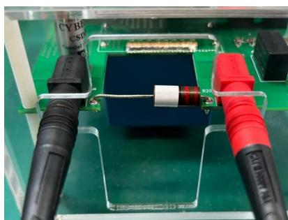
电流探头可以直接夹在无感电阻上
